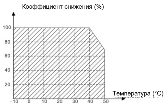
Рисунок 3-2. Снижение номинальной мощности преобразователя частоты GD20 в зависимости от температуры окружающей среды.
