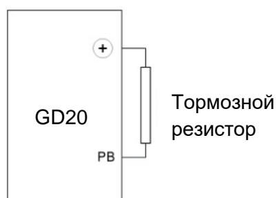
Рис. 12-3. Схема подключения тормозного резистора
