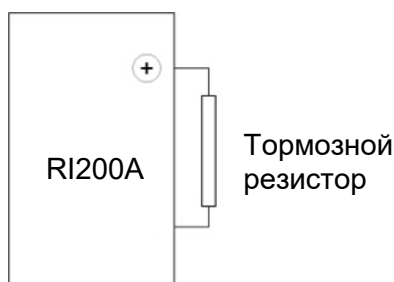
Рис. 12-3. Схема подключения тормозного резистора
